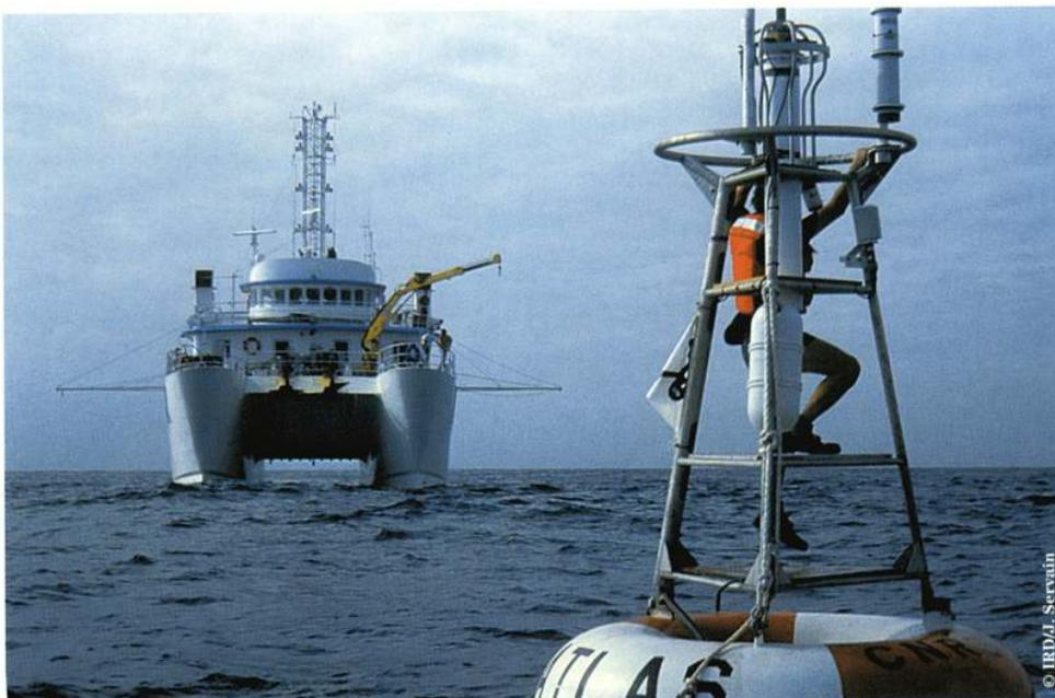
Les programmes internationaux d'étude du climat stimulèrent l'observation de l'océan. Ici la maintenance d'une bouée soutenant des instruments de mesure immergés et de surface.
