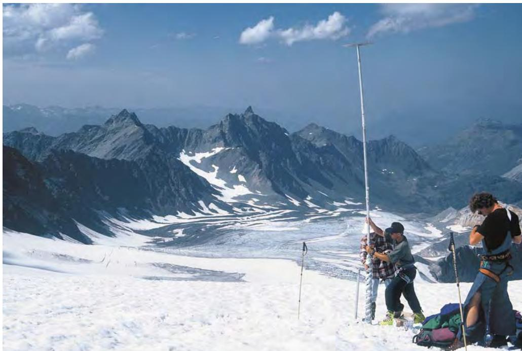
Mesure de l'accumulation de neige au mois de septembre réalisée avec un carottier manuel dans la partie haute du glacier de Gébroulaz (Haute-Savoie). Les carottes extraites sont pesées et mesurées pour convertir les épaisseurs de neige et de névé en équivalents-eau. Sur cette photo, on distingue bien la zone d'accumulation (blanche) et la zone d'ablation (sombre).
