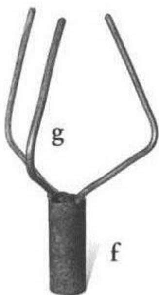
Figure 118. Support du cône plastique
