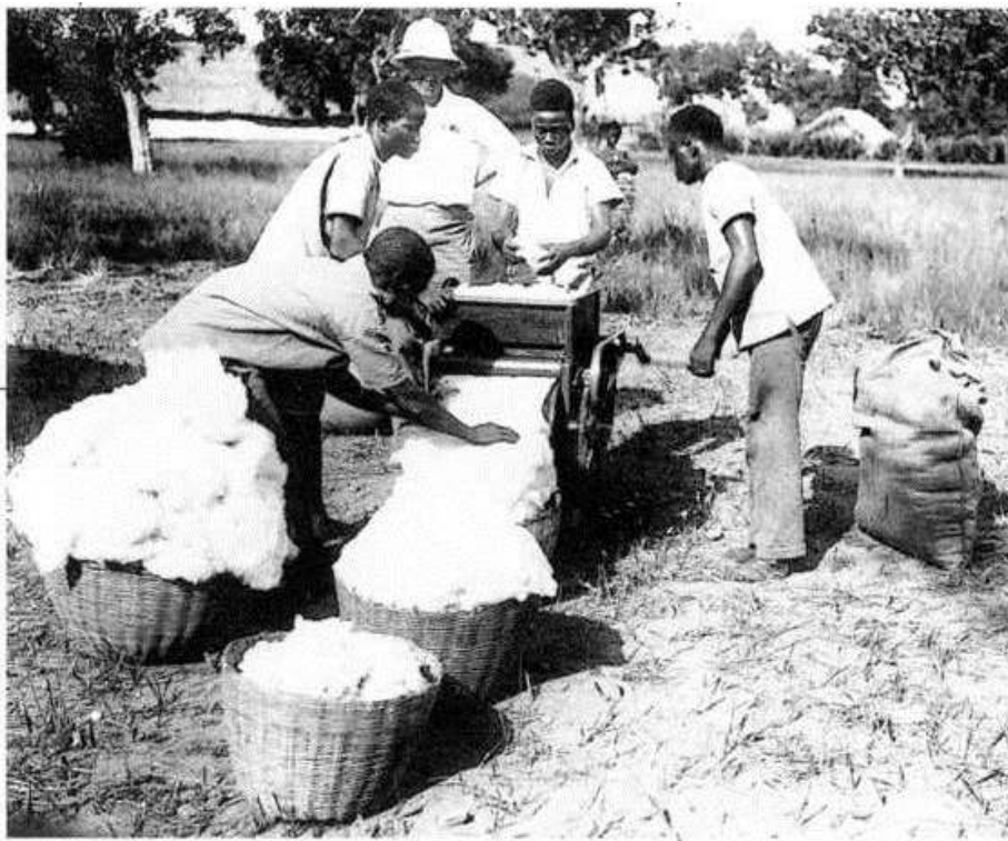
Une égreneuse de coton manuelle en activité (Bouaké, environ 1915). Première mécanisation de la filière du coton. (Avec l'aimable autorisation des Archives nationales de France, section d'outre-mer - Ansom.)
