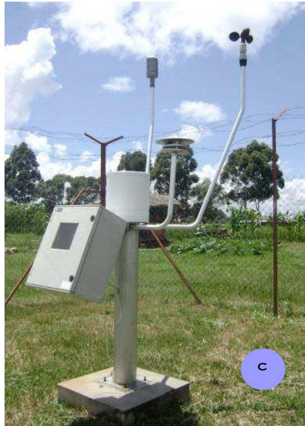
Figure 1. Une parcelle d'érosion (A et B) et station météorologique automatique CIMEL (C)
