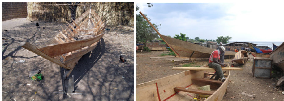
FIGURE 12 – Actuellement, l'ensemble des bateaux est construits avec des planches clouées ensemble. L'étanchéité est assurée par des baguettes de métal recouvrant l'étoupe goudronnée insérée en force entre les planches. À gauche, Speke Bay Lodge, Tanzanie (© IRD / D. Paugy), à droite, région d'Entebbe, Ouganda (© IRD / C. Lévêque)
