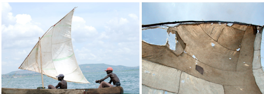
FIGURE 11 – Les pêcheurs les moins riches n'ont souvent pas les moyens de s'acheter une voile manufacturée. Pour y remédier, ils fabriquent des voiles de fortune en cousant entre eux des sacs en plastique de récupération. À gauche (© IRD / D. Paugy), à droite (© C. Faudemay)
