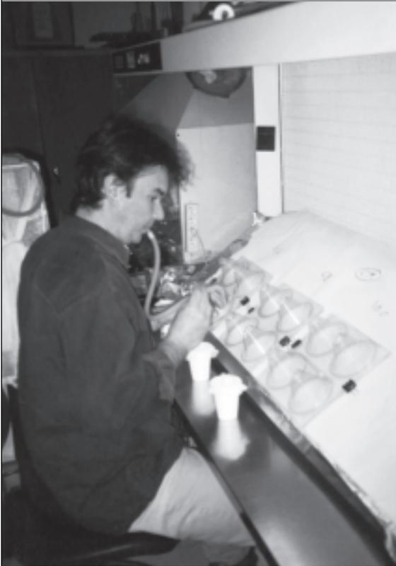
**Cônes OMS utilisés pour mesurer l'efficacité d'un insecticide en imprégnation de moustiquaire (temps de contact des moustiques avec le tulle moustiquaire : 3 minutes).**
