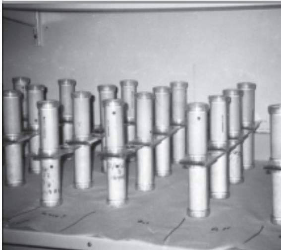
**Cylindres-tests OMS utilisés pour la sélection de la souche Kou et pour mesurer la sensibilité des moustiques aux insecticides.**
