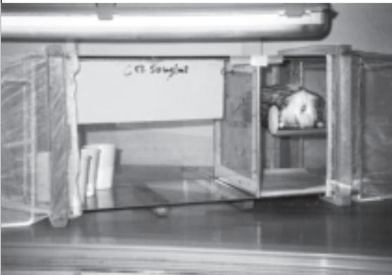
**Tunnels expérimentaux utilisés pour mesurer l'efficacité d'un insecticide en imprégnation de moustiquaire (temps de contact des moustiques avec le tulle moustiquaire : 15 heures).**
