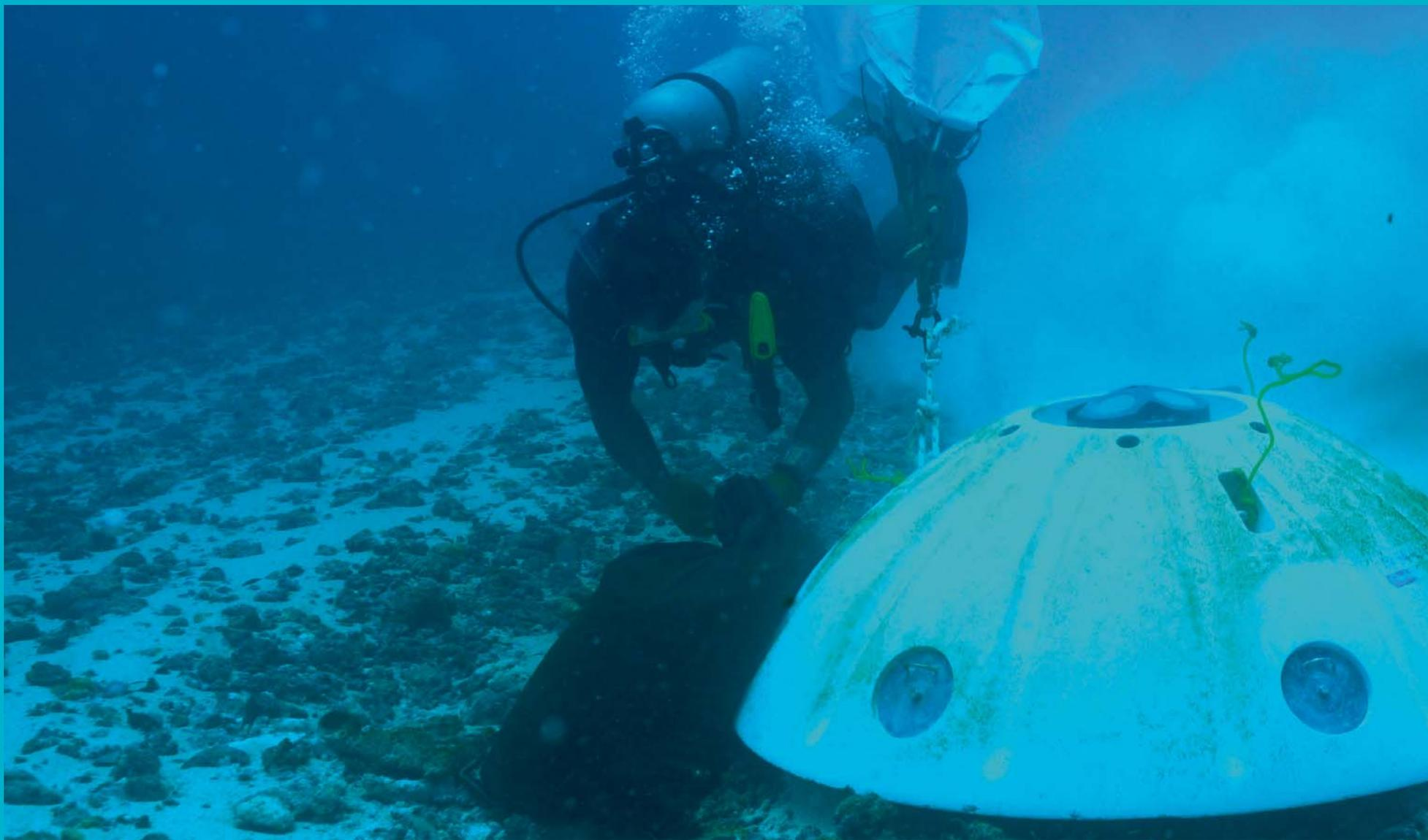
*Installation d'un courantomètre dans la passe de Takaroa (atoll des Tuamotu). © J. Orepuller*
