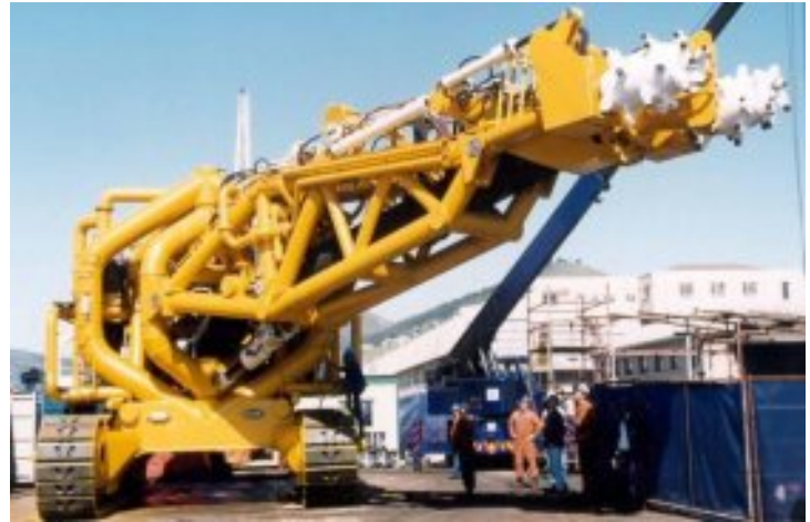
Figure 1 — Un bateau d'exploitation de diamantes (à gauche) ; un « crawler /cutter », engin d'exploitation qui fonctionne sur le fond marin (à droite).
