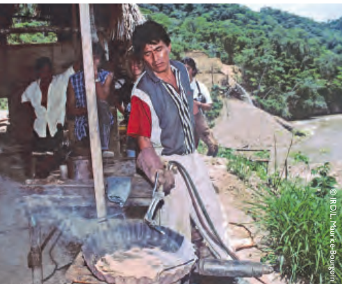
Queima de amálgama de ouro/mercúrio em uma cooperativa de ouro da Amazônia boliviana (emissão direta de vapor de mercúrio para a atmosfera).
