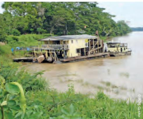
Draga de garimpo e seu rebocador na fronteira Bolívia-Brasil. Esta área está muito poluída pelos resíduos da mineração de ouro, incluindo o mercúrio.
