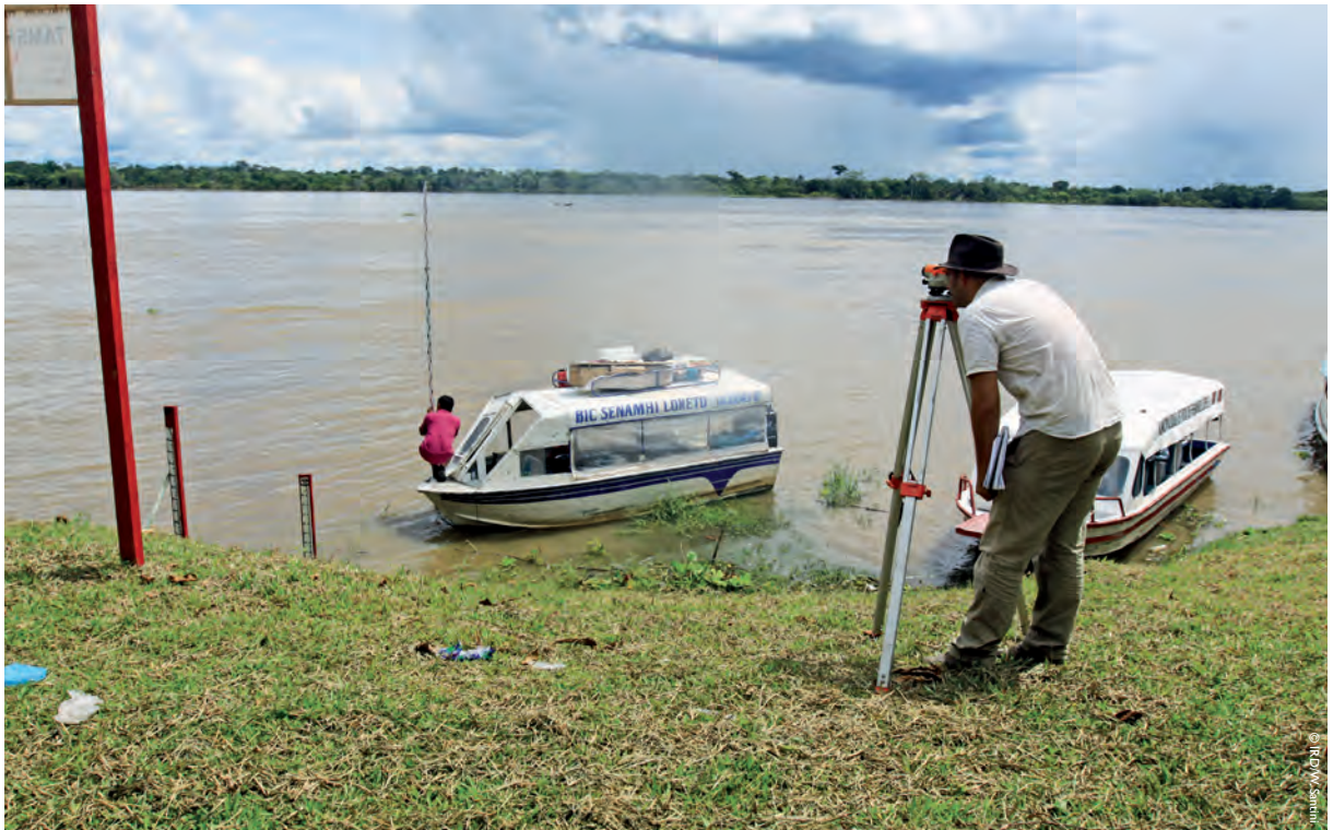
Mesure des niveaux de l'eau de l'Amazone (programme HyBAm), Pérou.
