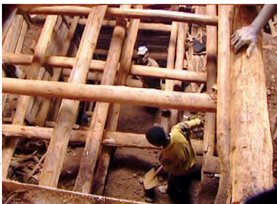
Illustration 3 Chantier artisanal d'exploitation de l'or, puits d'extraction, site de Butare à Mabayi (province de Cibitoke, Burundi)
