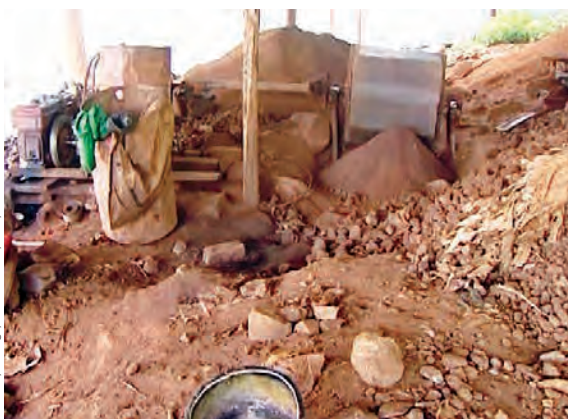
Illustration 4 Concassage mécanique des débris de roches extraites, site de Butare à Mabayi (province de Cibitoke, Burundi)
