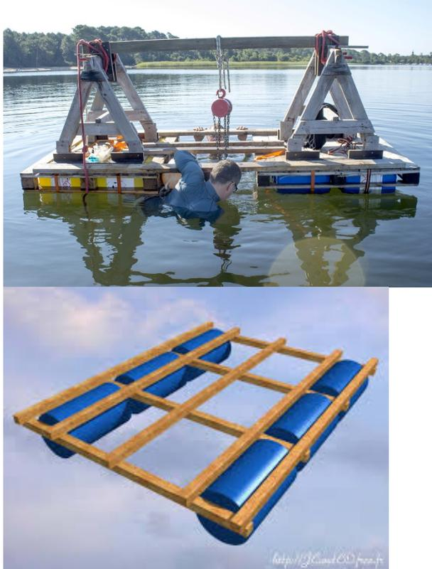
**Figure 13 : Deux types de radeaux en bidon, en haut avec une chèvre sur potence (descente précise).**
