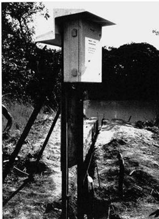
PHOTO 1. La plate-forme hydrologique et son alimentation par panneau solaire, reliée au capteur de pression, sur le Sankarani à Sanankoro, Guinée (Photo Michel GAUTIER, ORSTOM).
